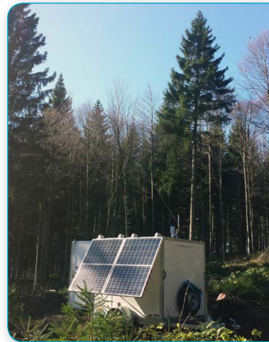
Bild oben: LIDAR-Messung am möglichen Windstandort bei St. Georgen ; Foto: solarcomplex
